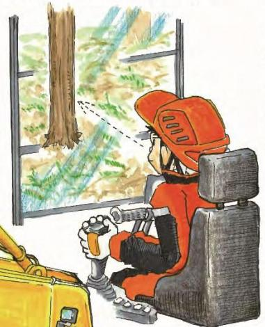
両手両足を使って運転とアームの操作を同時に使う。高度な知識と、的確な運転技術に加え、残す木は決して傷つけないディリケートな気配りが必要。
